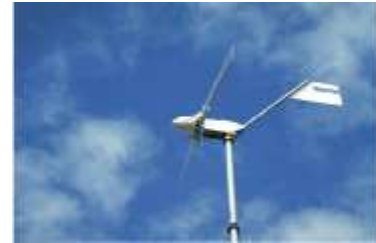
Petite éolienne alimentant en électricité une maison isolée, dans l'Aude.
